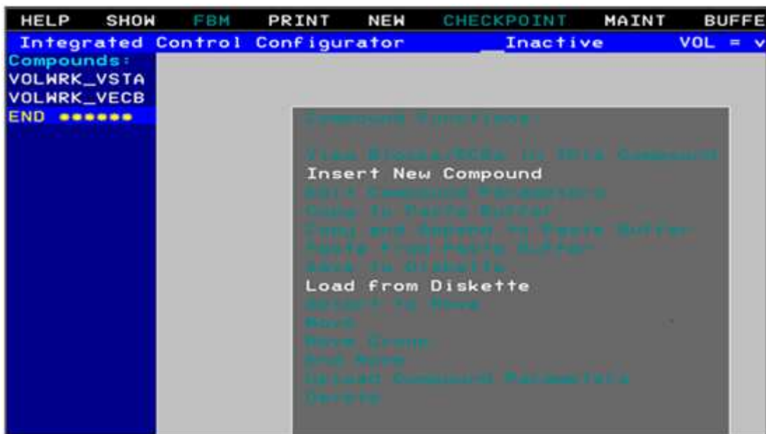
Figure A.7 Insertion d'un nouveau projet.
