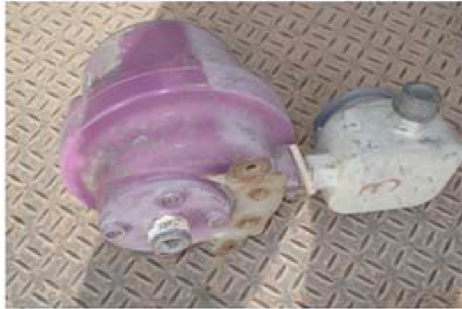
Figure I. 7 Détecteur de flamme.
