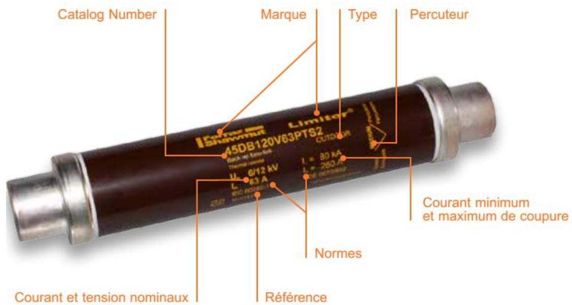
**Figure 0.5** Les données se trouvent sur le fusible
