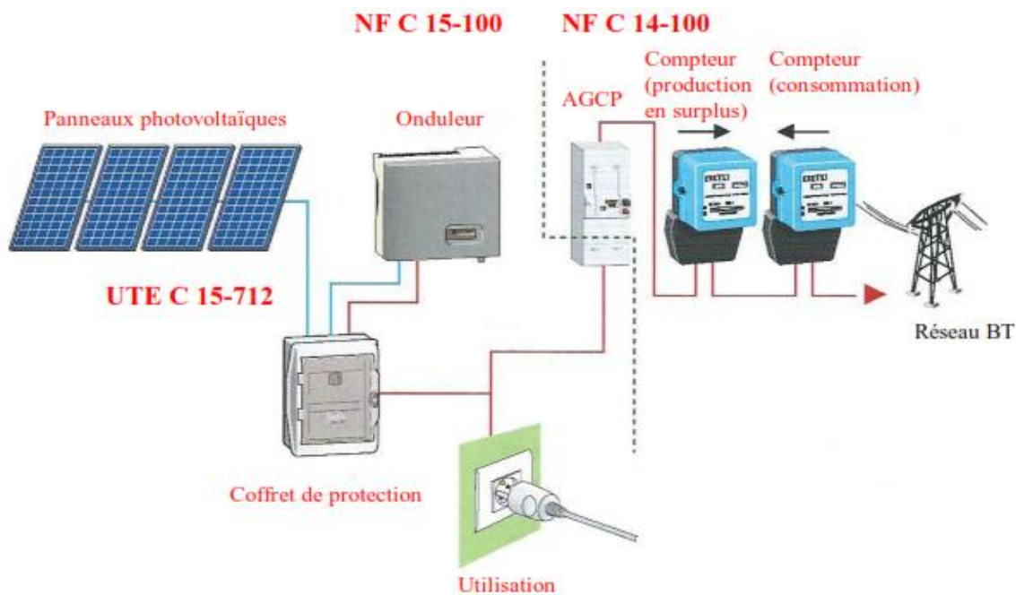
Figure II.5 schéma d'Installation avec injection de surplus
