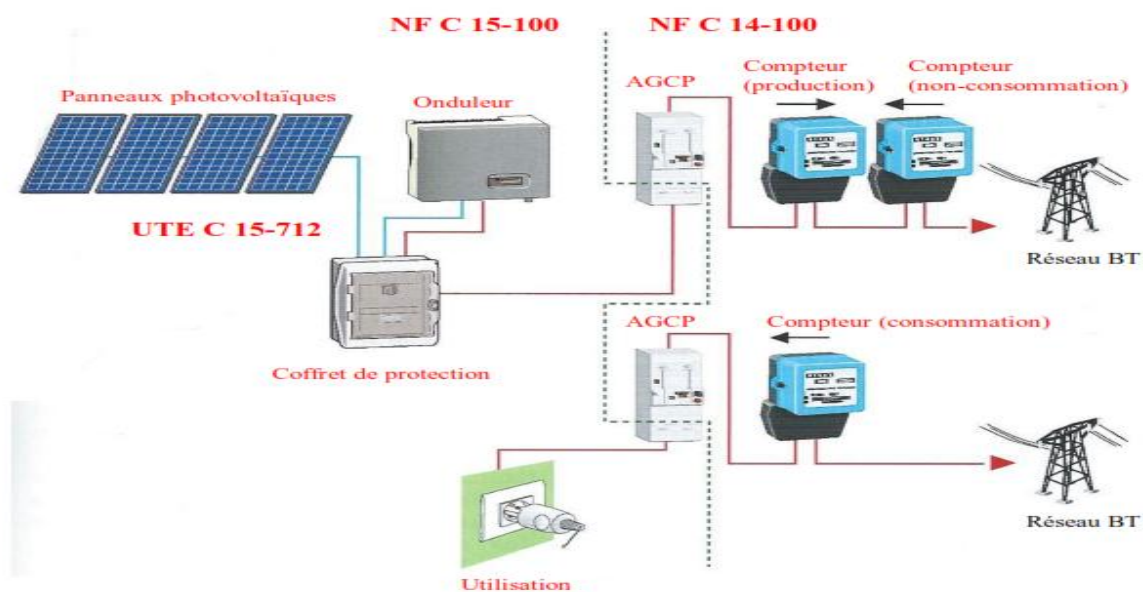
Figure II.4 schéma d'Installation avec injection totale
