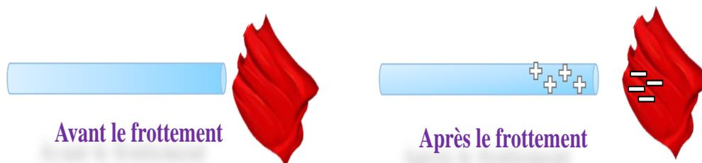
Figure I.1 : L'électrification par frottement
