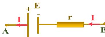
*Figure III.8 : Schéma équivalent d'un générateur de tension*
