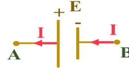
Le générateur délivre une tension  $E$  ( $V_{AB} = E$ ).
