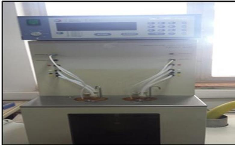
**Figure 2.16 :** Bains viscosimétriques
