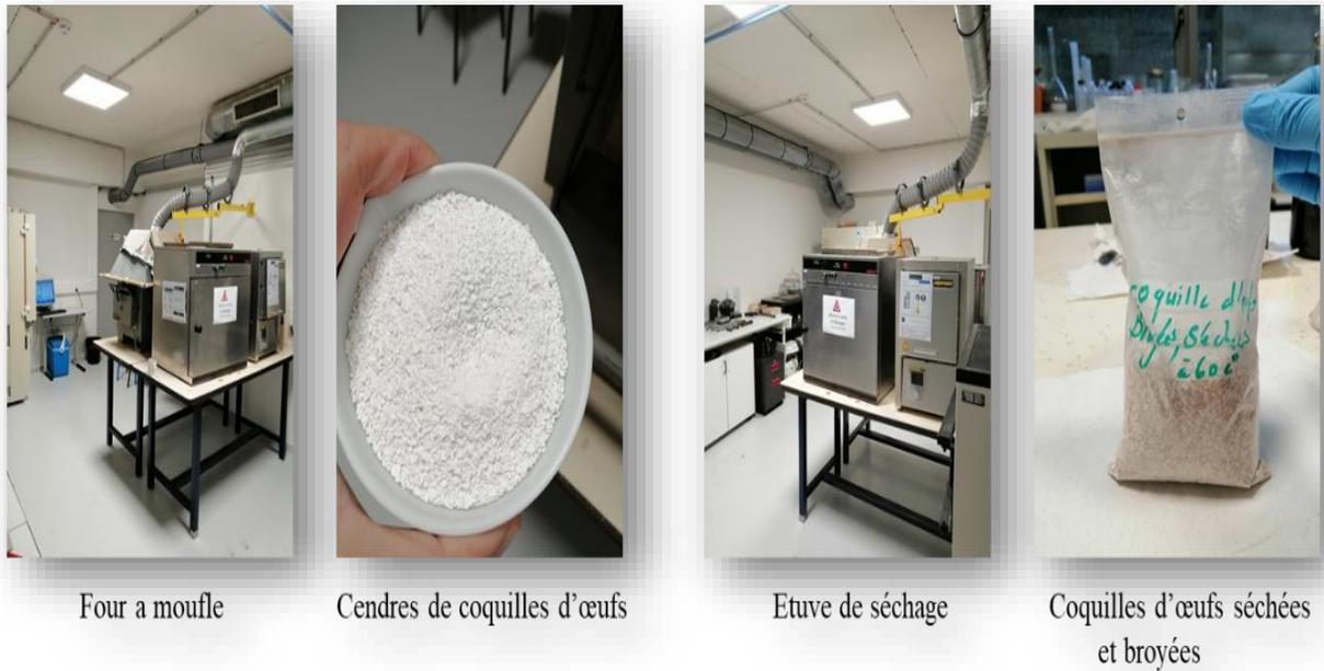
Figure 2.31 : Matériels utilisé pour la préparation du catalyseur.
