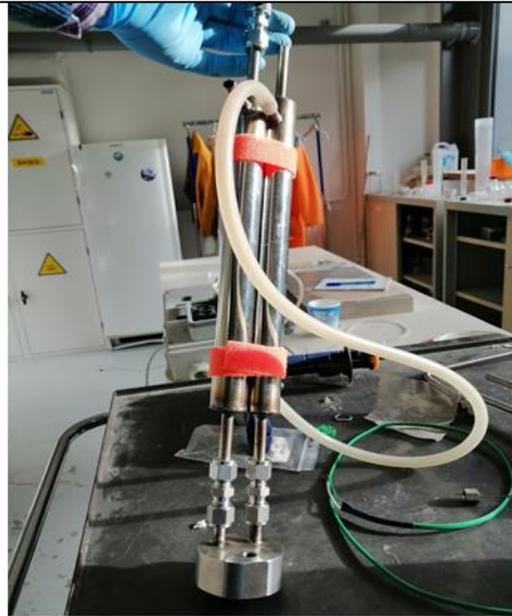
*Condenseur de banc d'essai pour la condensation de vapeur de pyrolyse*
