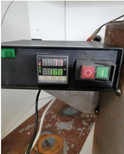
*Dispositif de contrôle de température du banc d'essai (PID)*
