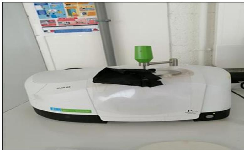
**Figure 2.18 :** Analyseur FTIR Perkin Elmer
