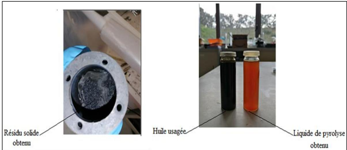
**Figure 3.39** : Produits liquides et solide de pyrolyse obtenus
