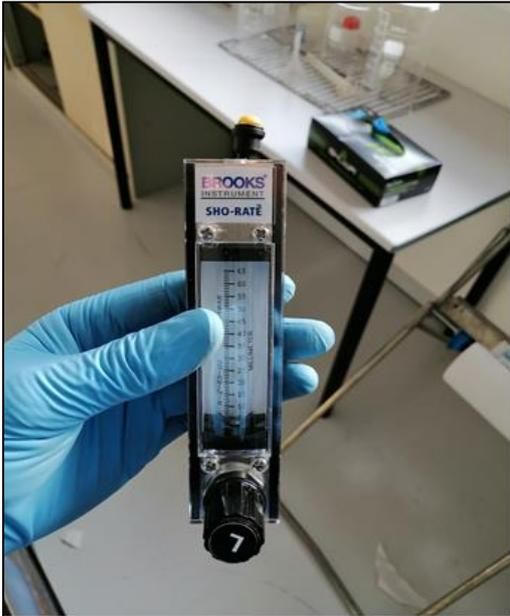
*Débitmètre pour contrôle de l'azote (inertage)*
