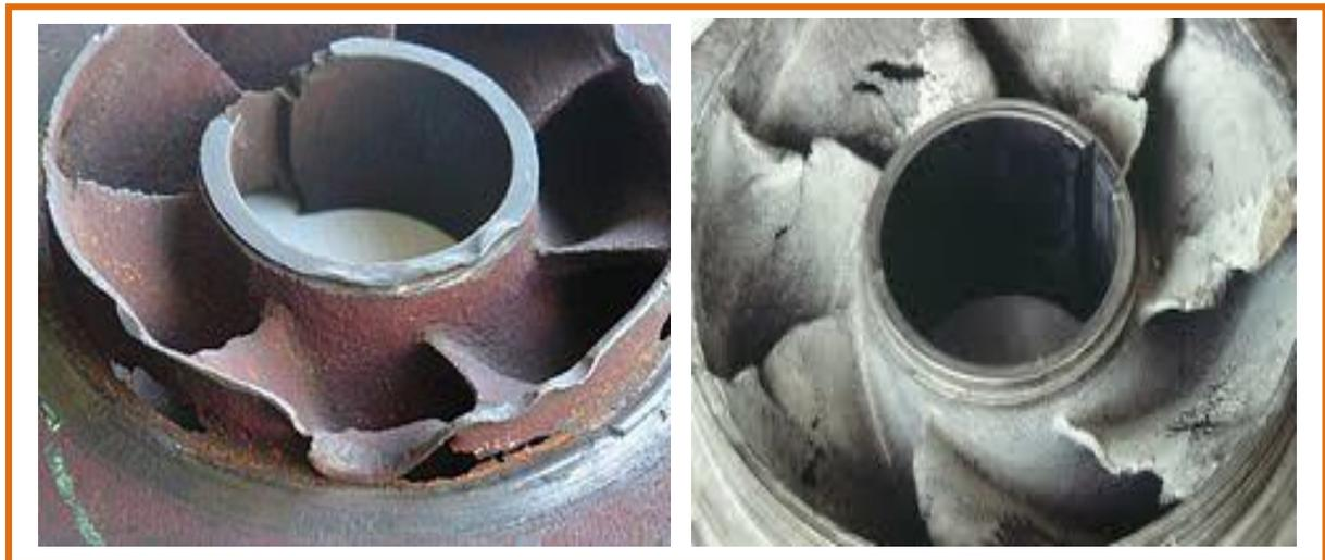
Figure I. 7 : endroits attaqués par la cavitation
