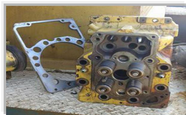
Figure II.8-Culasse et plaque de culasse
