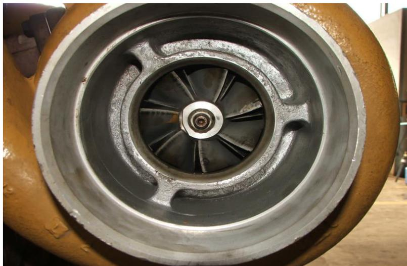
Figure II.18 -La roue de compresseur
