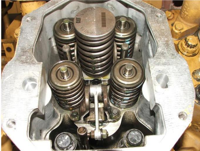
Figure II.15-Soupapes d'admission et d'échappement
