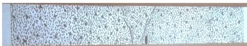
Figure IV.15: éprouvette de traction avec fissure dans la ZAT
