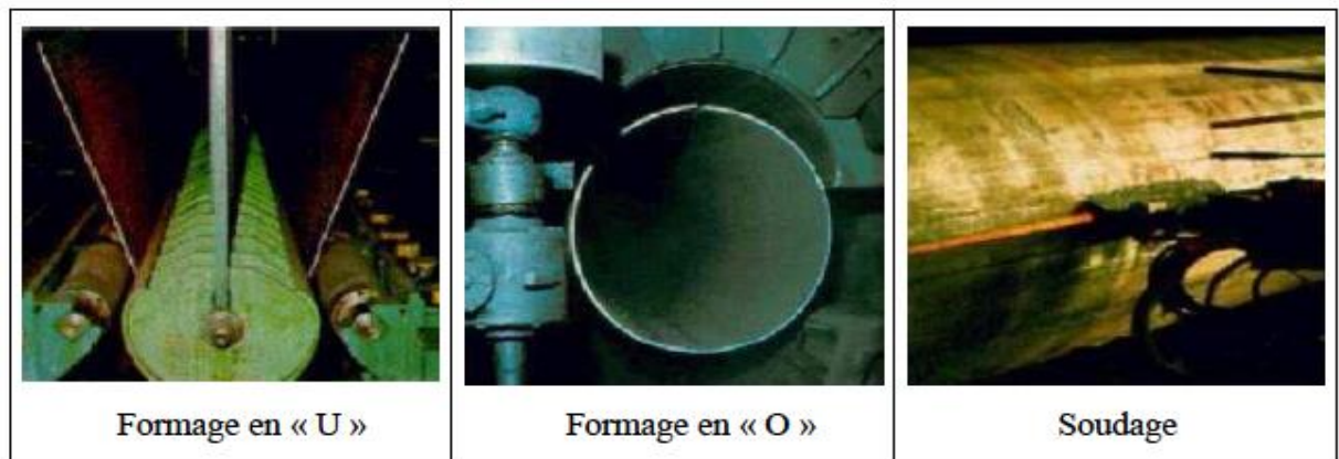
Figure I.7 : Photos de la mise en forme des tubes par le procédé « UOE »
