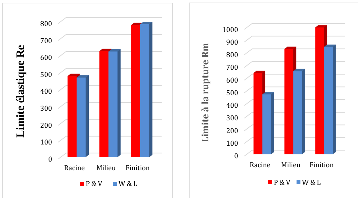
Figure V.9.b) : Histogrammes des propriétés de traction de la zone fondue ZF (valeurs estimées à partir de la dureté)
