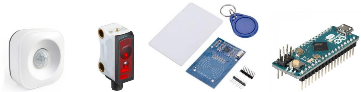
(a) Motion Sensor (b) Photo Sensor (c) RFID Reader + RFID Card (d) Micro-controller unit
