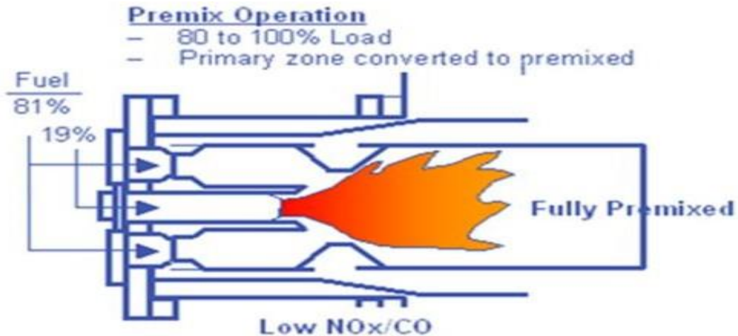
Figure III-8: Représentation du mode premix
