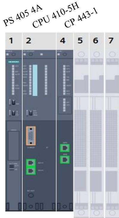
**Figure IV.12 : Configuration matérielle du S7-410-5H**
