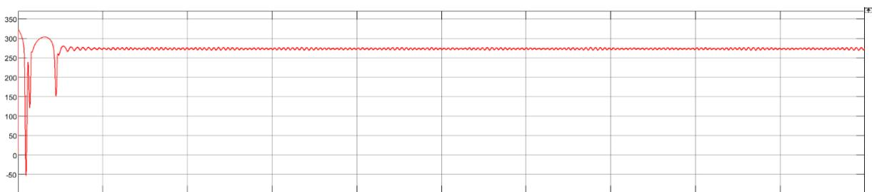
Figure IV. 5 La tension maximale à la sortie du PV après l'application de l'MPPT
