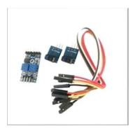
Figure 1.11.Odometry sensor
