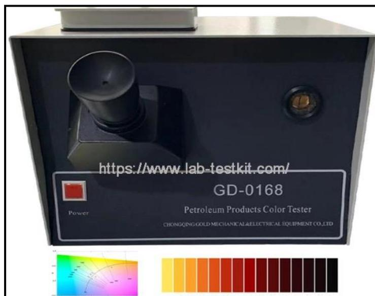
**Figure II-7:** l'appareil de la détermination de la couleur "calorimètre" (17)
