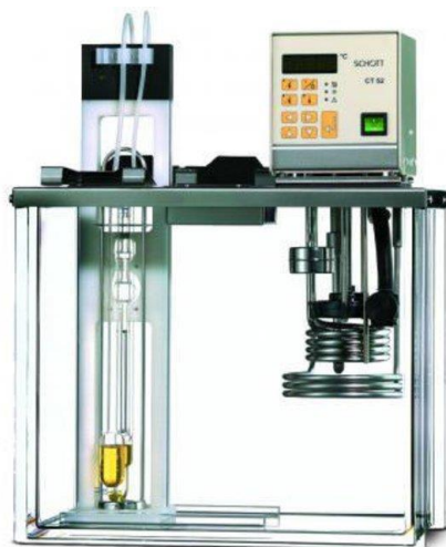
Figure II-1 Viscosimètre capillaire de type UBBELOHDE
