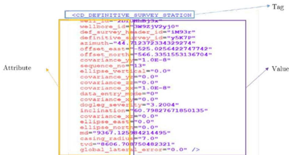
FIGURE III.3 – Exemple d’un fichier DDR de type XML)
