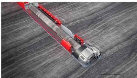
(a) Illustration d'une opération de carottage conventionnel
