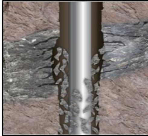
Figure III-3 : Forage à travers des roches fracture naturellement(Hossain and M. R. Islam, 2018)
