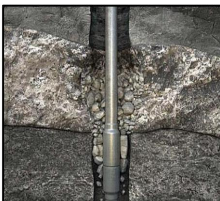
Figure III-6 : Forage à travers des formation non consolidée (Hossain and M. R. Islam, 2018)
