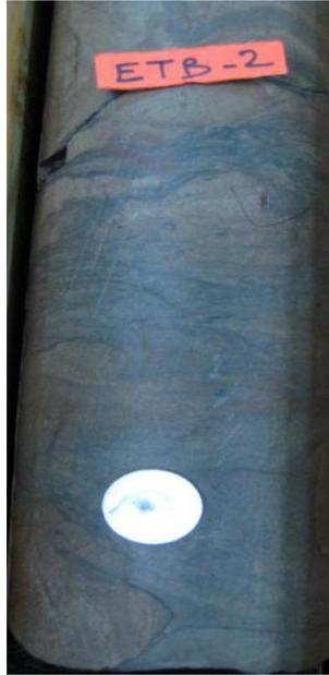
Figure.18 : Slumps ETB-2, C2, 3438-3439 m
