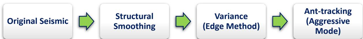
Figure 56 - Workflow de calcul d'un attribut d'ant-tracking
