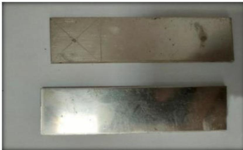
*Figure 23 : Tôle en alliage d'aluminium 7075-T6.*
