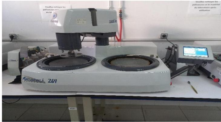
Figure 35 : MECATECH 264 (Polissage automatique)
