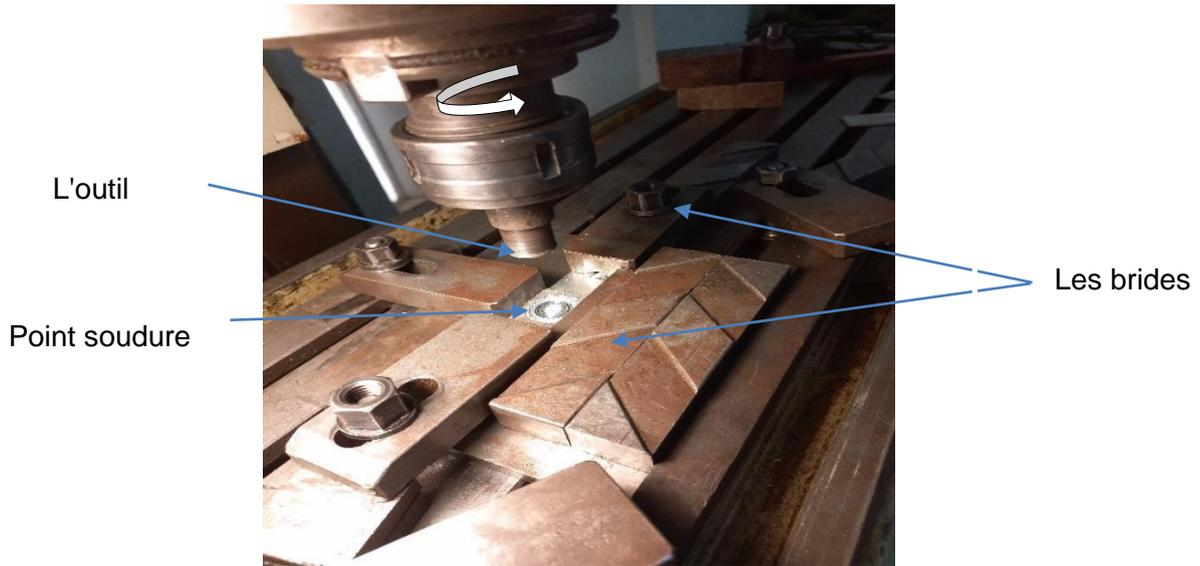
Figure 27 : système de bridage
