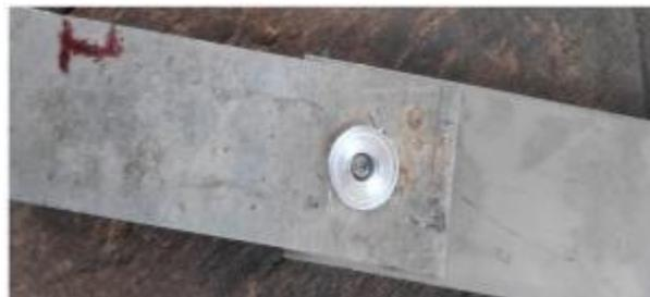
Figure 6 : Surface supérieure de soudage par points [18]
