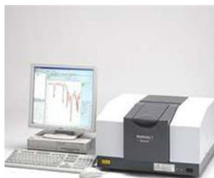
Figure 3.17: Spectromètre infrarouge (FT-IR)
