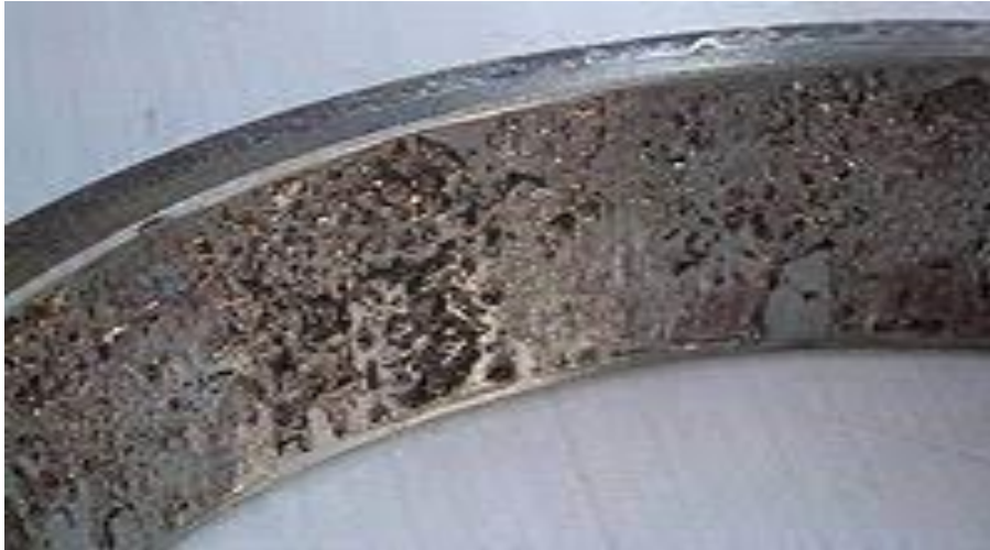
Figure 1.6 : une bande usée par fatigue
