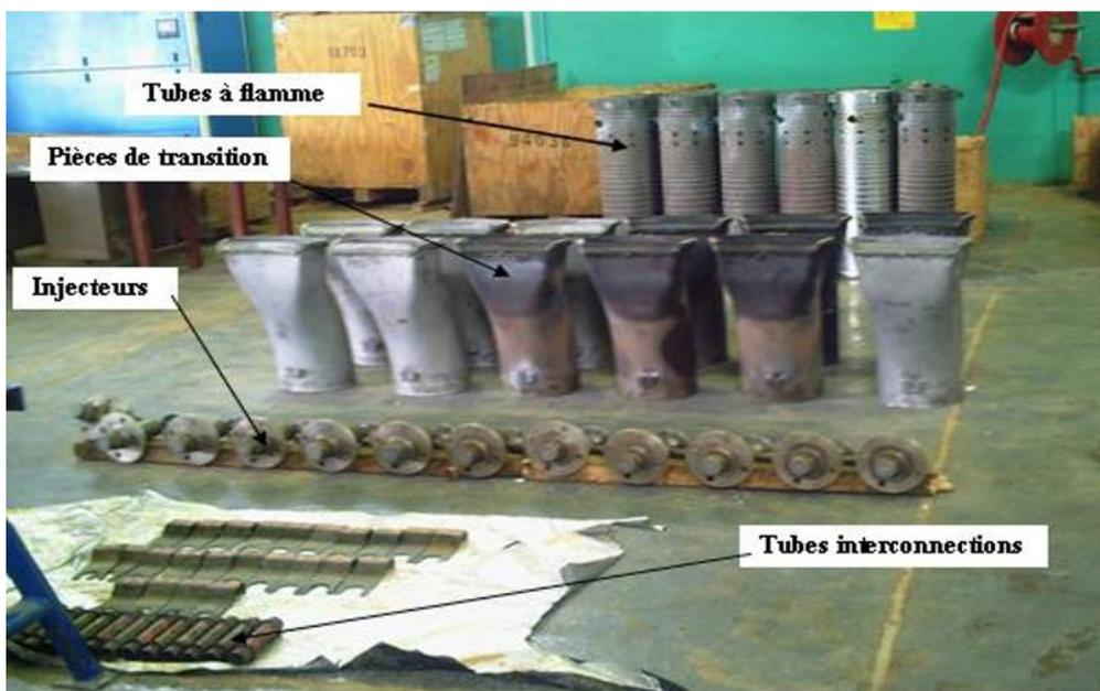
Figure 2-13: Composants de la section de combustion
