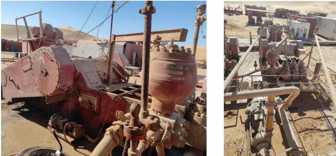
Figure 1.4 : La pompe à boue de RIG ENF#15.
