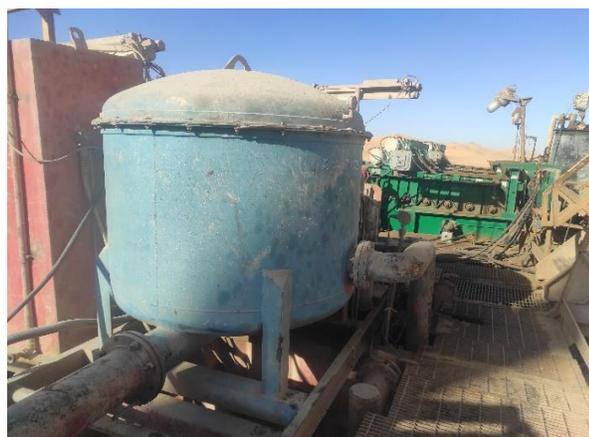
Figure 1.8 : Dégazeur de boue de rig ENF#1
