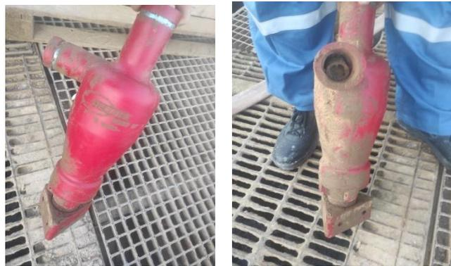
Figure 4.3 : Cône de desilter après l'inspection visuelle
