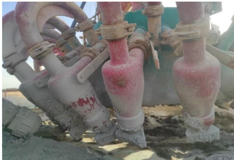
Figure 3.4 : Inspection visuelle de desilter
