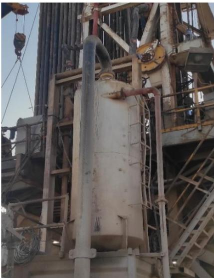
Figure 1.7 : Séparateur verticale de gaz de rig enf#15
