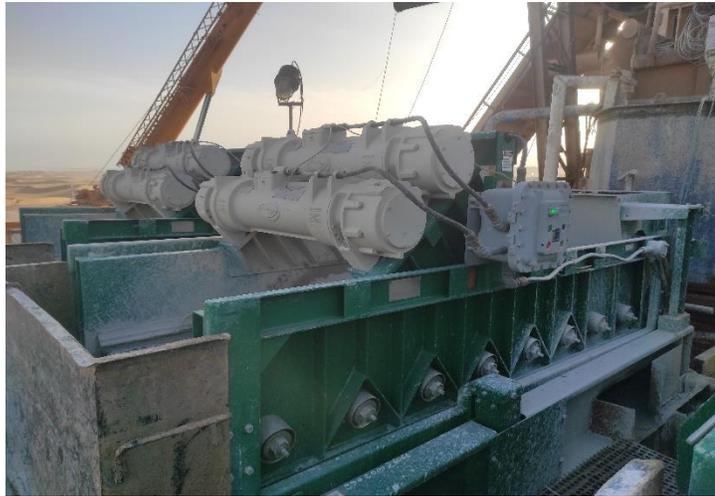
Figure 1.6 : Tamis vibrant de RIG ENF#15.
