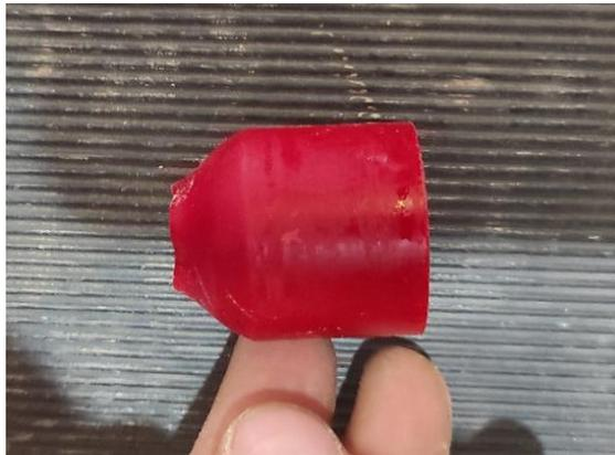
Figure 4.5 : Pièce d'usure de desilter
