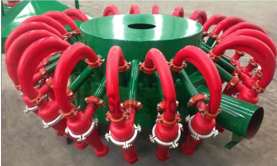
Figure 1.12 : Desilter de mud cleaner marque derrick.
