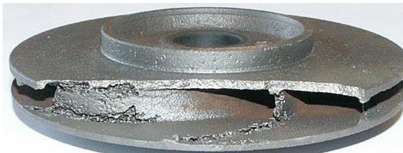
Figure 2-8 : roue de pompe a double aspiration cavité
