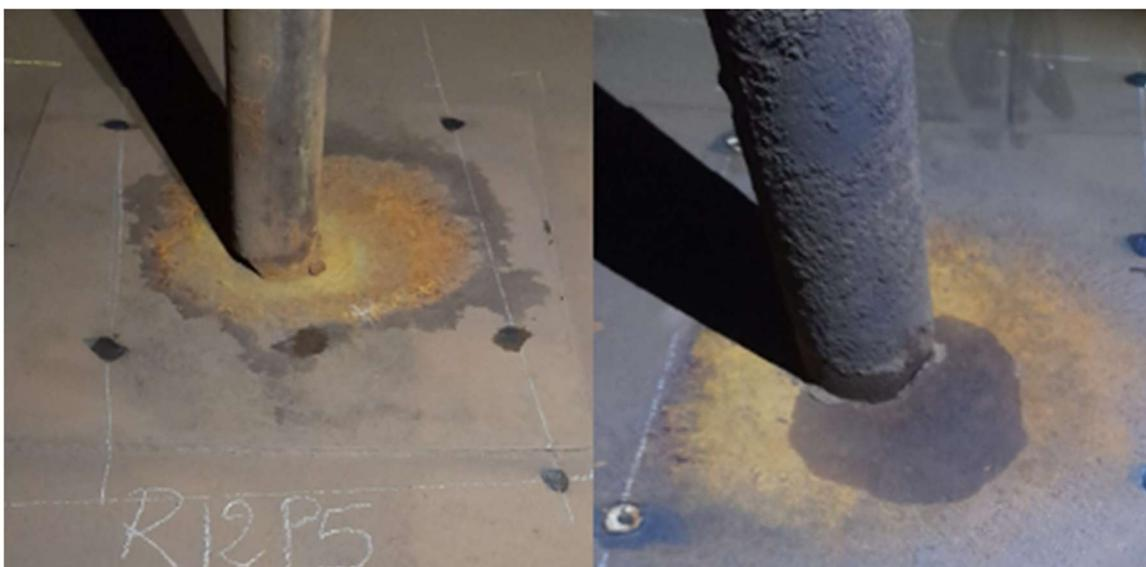
**Figure IV. 24 : défaut détecte par œil dans les Supports.**
