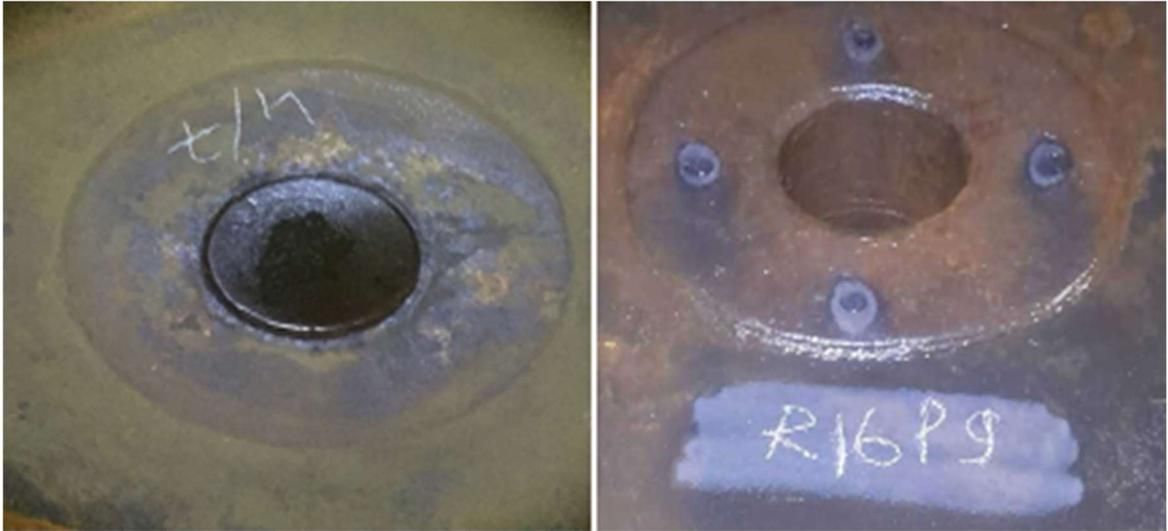
Figure IV. 25 : détection des défauts par vision des Purges
