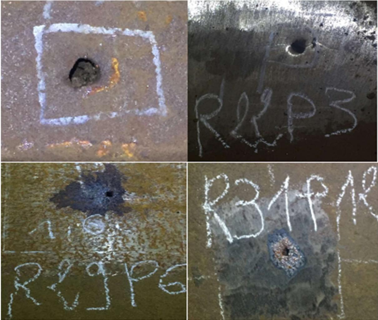
**Figure IV. 27: Defaut détecté par l'inspection visuelle dans la surface du bac**
