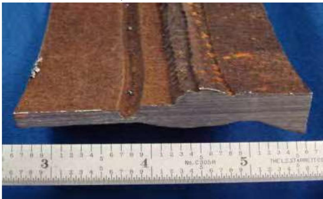
**Figure II. 8 corrosion par les amines attribues une augmentation de  $\text{CO}_2$**
