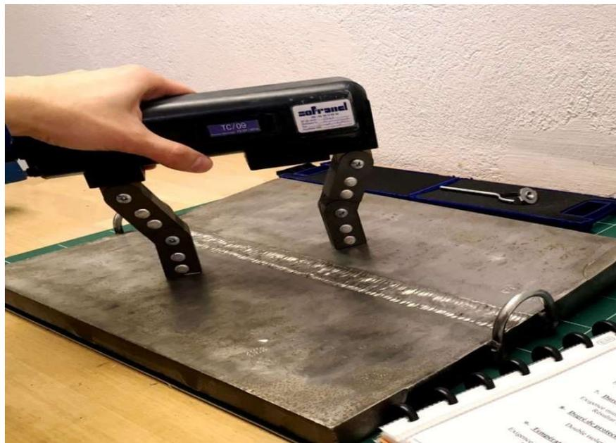
Figure III. 15: sonde de magnétoscopie
