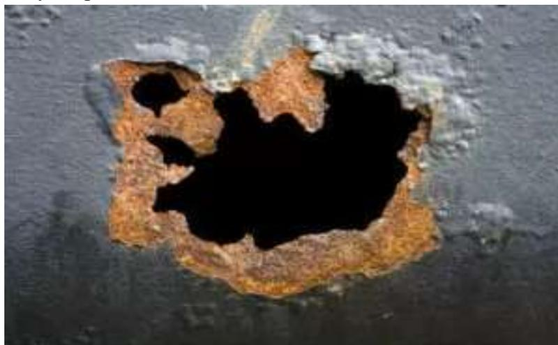
**Figure II. 14: Processus de fatigue-corrosion à partir d'une piqûre de corrosion**
