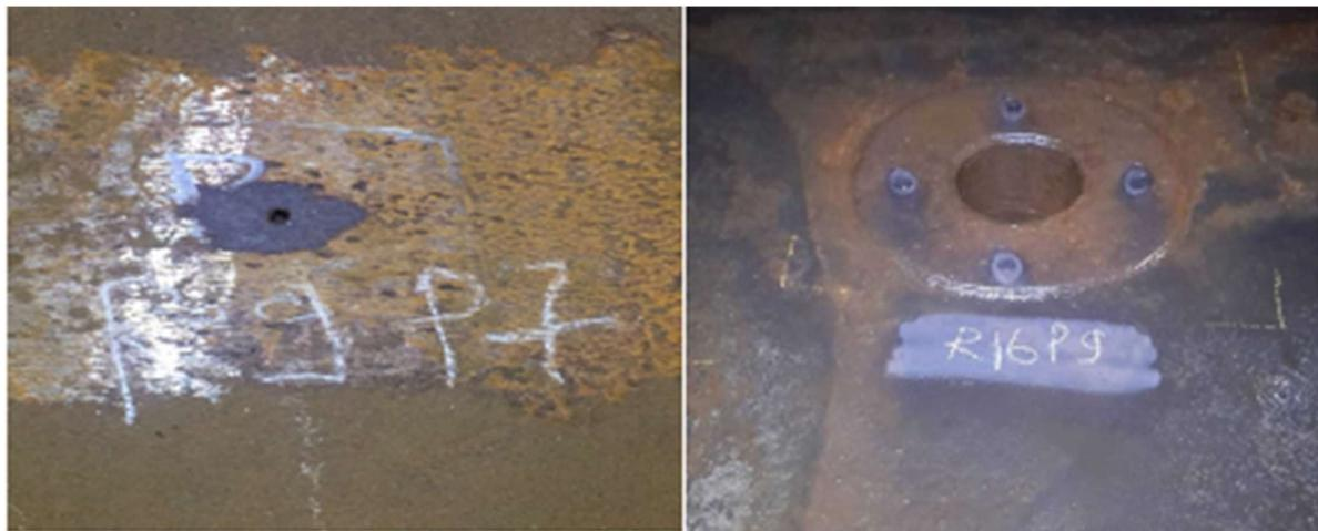
Figure III. 5: piqûre visibles à l'œil nu et corrosion généralisée au niveau du support
