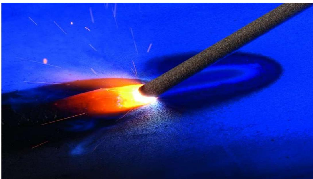
**Figure V.11 : électrode utilisée dans le procédé SMAW**
