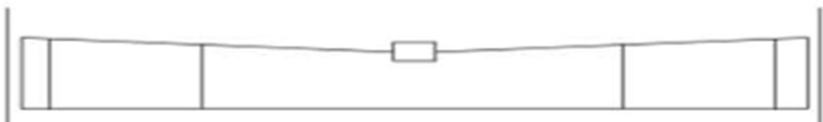
Figure I. 15: Type double pont, le caisson recouvre toute la surface du réservoir.
