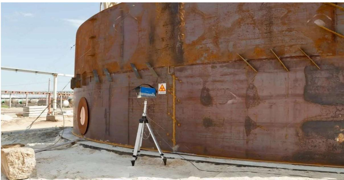
Figure III. 10: scanner de radiographie
