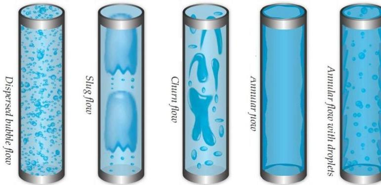
FIGURE 2.10 – Régimes d'écoulements verticaux
