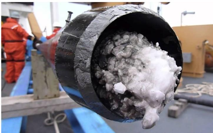
FIGURE 2.6 – Les hydrates dans la canalisation
