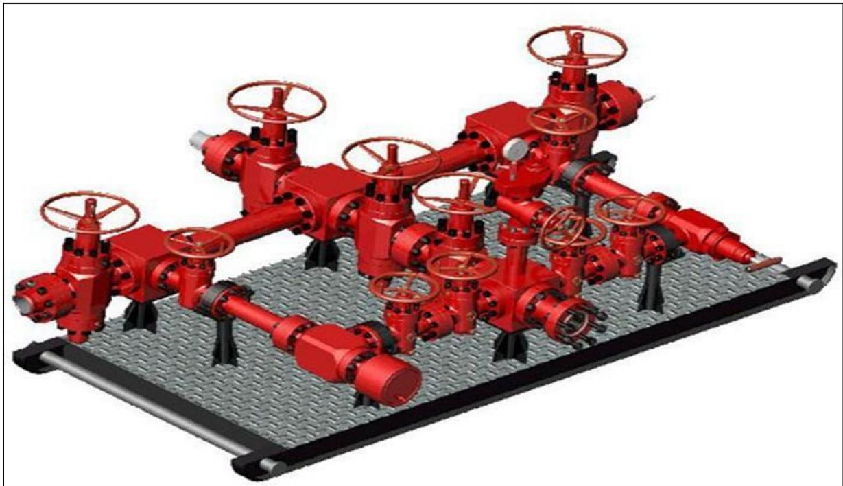
**Figure 2-9: Points de regroupement des puits (manifold). [8]**
