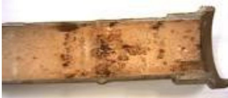
Fig I.2 : corrosion interne d'un tube.
