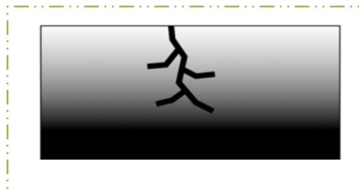
*Figure. II.13: Corrosion sous tension*
