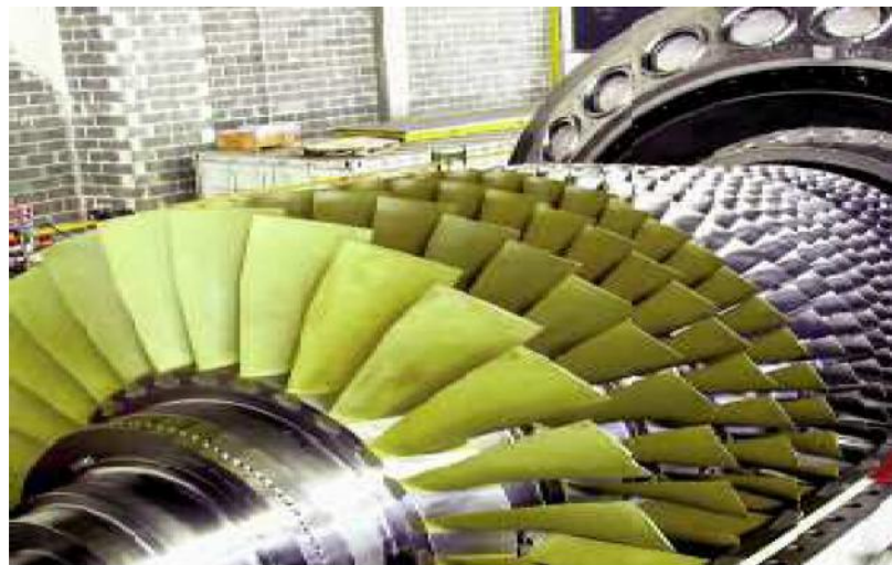
Figure IV- 5 : Compresseur (16+1) étage V 94. 3A.
