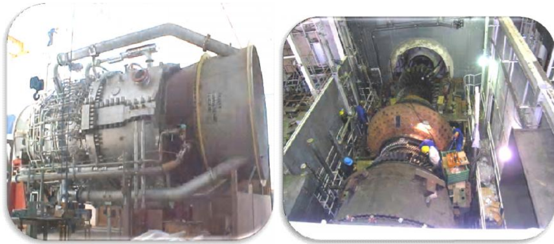
Figure I.4 : Vue externe et interne de la turbine V94.3A.
