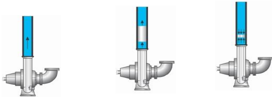
1. État stationnaire avant défaillance de la pompe
