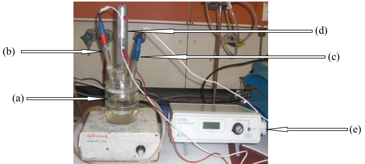
Figure II.11 Schéma de la cellule électrochimique. (a) cellule de mesure, (b) électrode de référence, (c) contre électrode en platine, (d) électrode de travail et (e) le potentiomètre.
