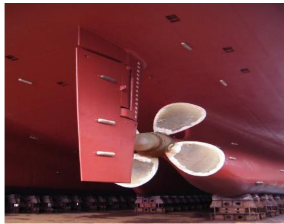
Figure I.11 Répartition d'anodes sacrificielles en zinc sur une coque de navire.
