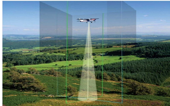
Figure 2.3 : Avion de détection optique de fuites [5]
