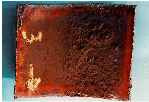
Figure 1.2 : Perte de métal due à la corrosion interne dans une paroi d'un gazoduc
