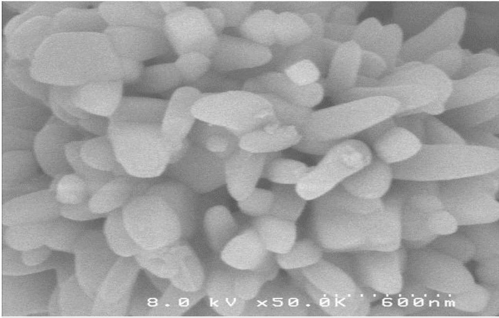
sur cette photo nous notons le grossissement des grains et apparition de joints de grains à la température de 1000°C.
