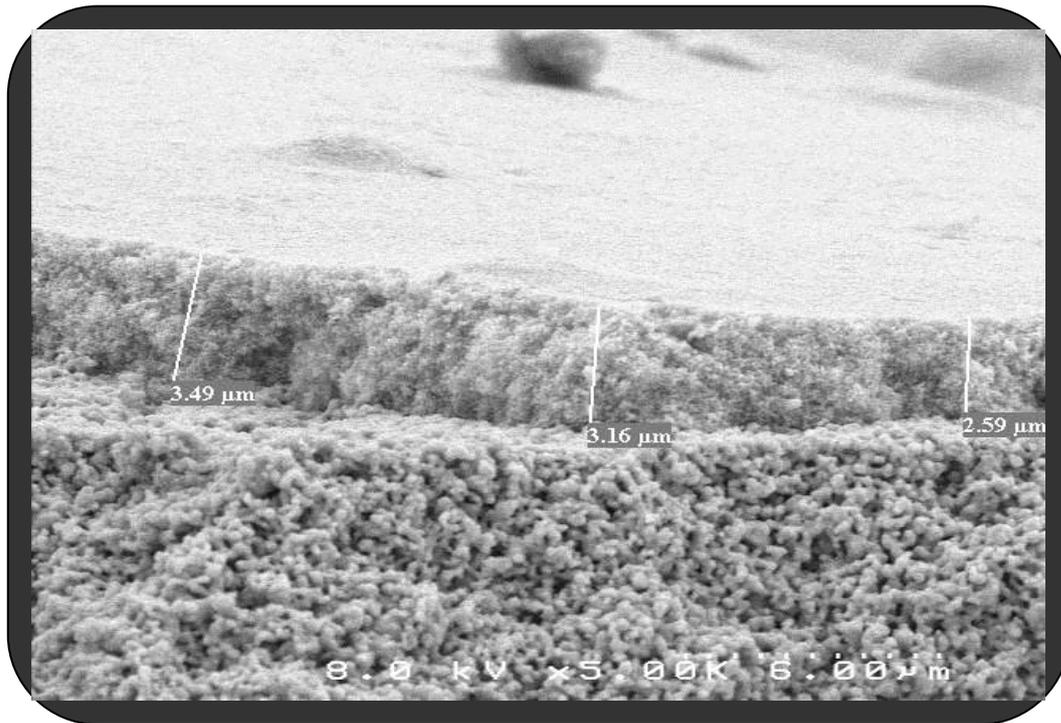
1: On note une bonne adhésion de la membrane  $ZrO_2$  sur le support Attapulgite lorsque le temps d'engobe est de 20 minutes
