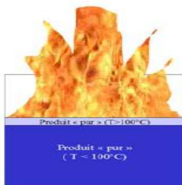
Figure IV.9 : Schéma de l'étape 1 de boil over en couche mince
