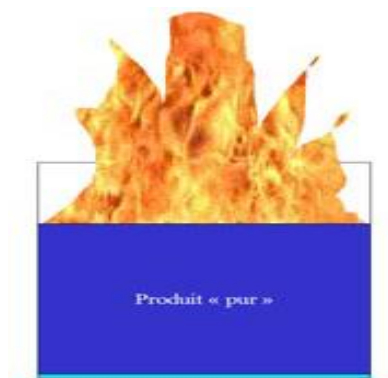
Figure IV.4 : Schéma de l'étape 1 de boil over classique
