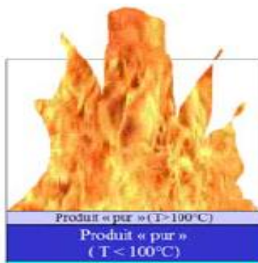
Figure IV.10 : Schéma de l'étape 2 de boil over en couche mince
