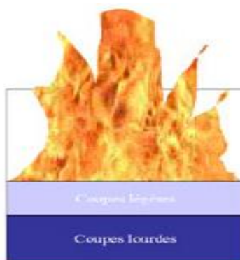
Figure IV.6 : Schéma de l'étape 3 de boil over classique
