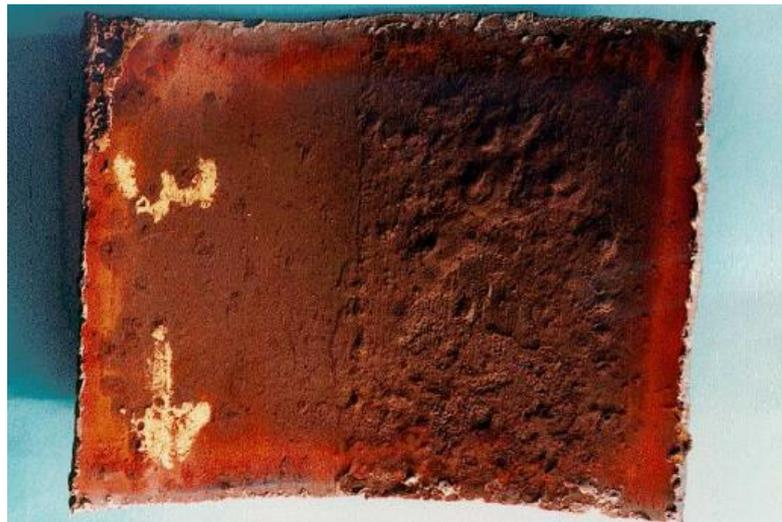
**Figure II 3:** Pertes de métal dues à la corrosion interne.
