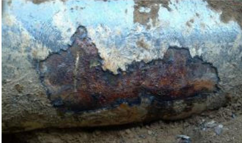
**Figure II 4:** Pertes de métal dues à la corrosion externe.
