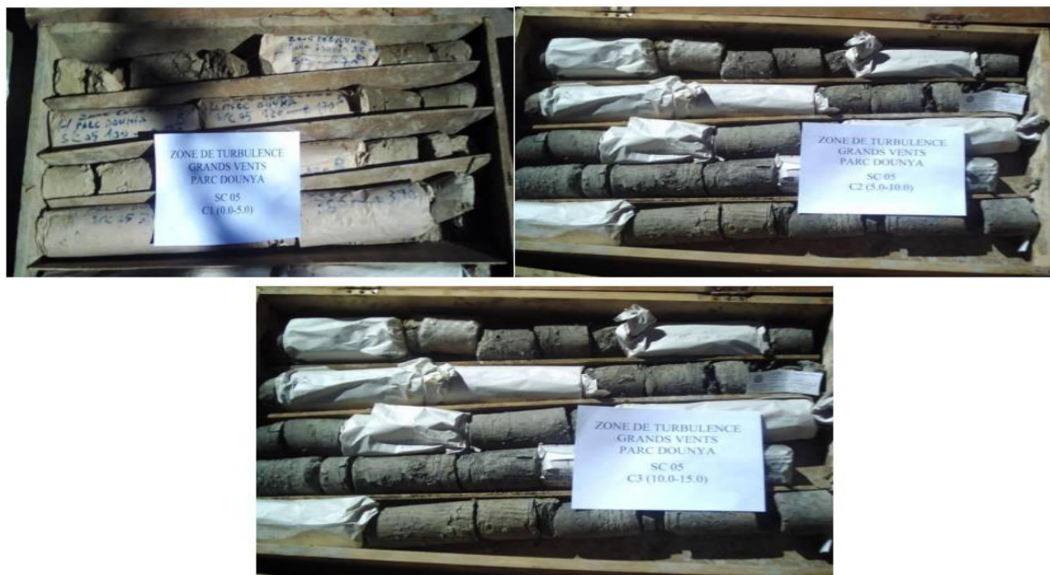
Figure IV.4 : Sondage carotté au niveau de la marne plaisancienne réalisé dans la région de Dely Brahim
