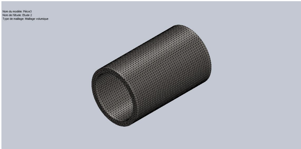
Figure 5 : information sur le maillage de la chemise.
