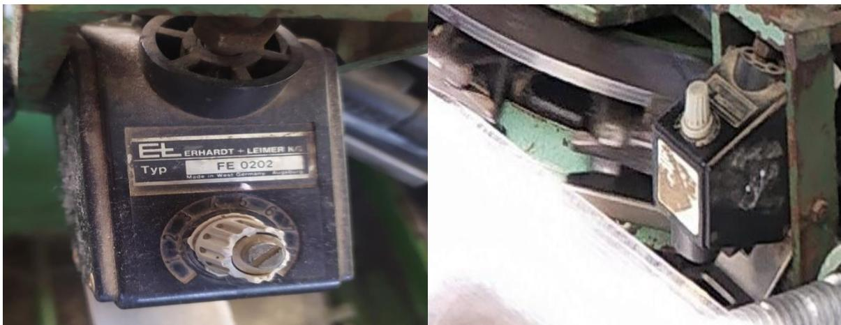
**Figure 2.8 : Capteur FE 0202**
