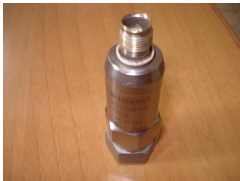
Figure IV.5 : Un accéléromètre de marque Schenck de type : AS-065
