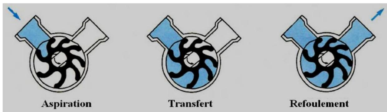
Figure 13 : Pompes à palettes flexibles.
