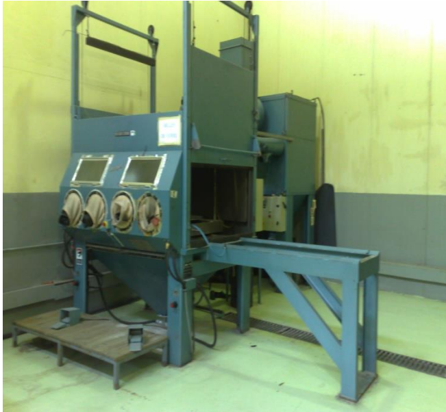
Figure (V-6) : l'appareil de sablage dans l'atelier nettoyage mécanique.
