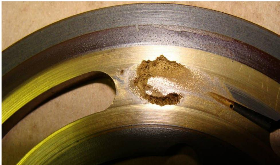
Figure-II-13-Dégâts de la cavitation
