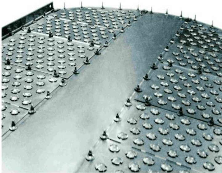
Fig III .11.plateau à clapets
