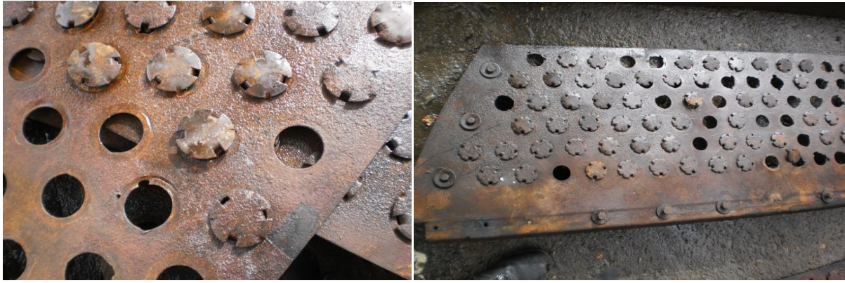
Fig .V.4. manque des clapets sur les plateaux
