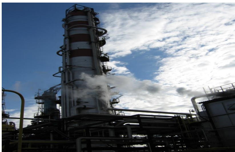
Fig III -1 Colonne de distillation atmosphérique
