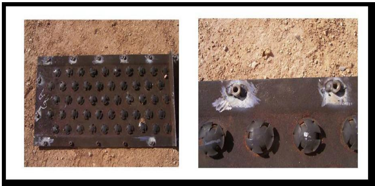
Fig .V.5. la réparation d'un plateau à clapets-
