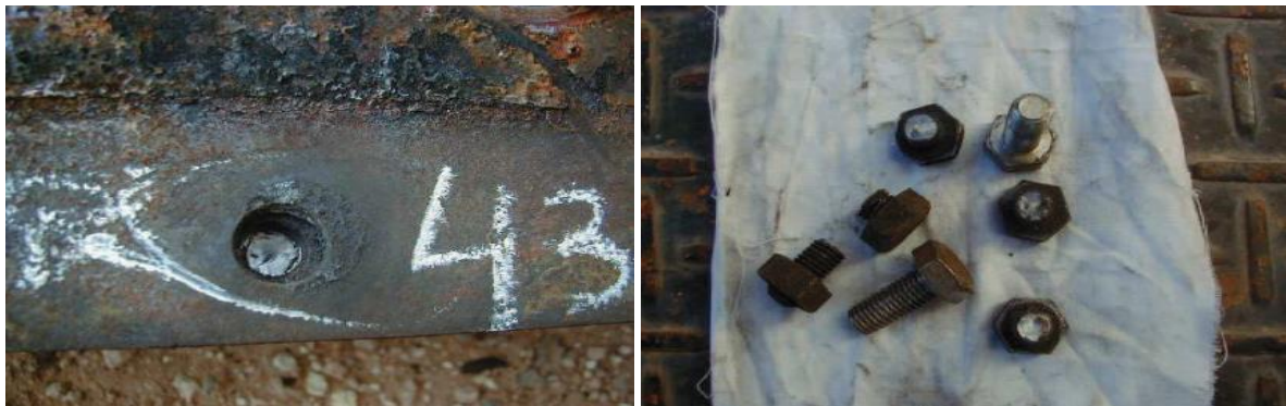
Fig .V.3. Cisaillement des boulons de fixation de plateaux à clapets
