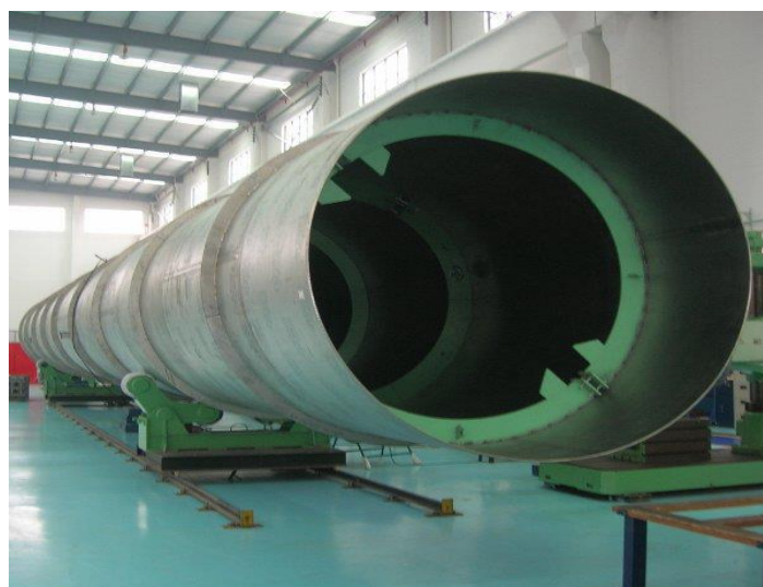
Fig III.4 construction des viroles des colonnes
