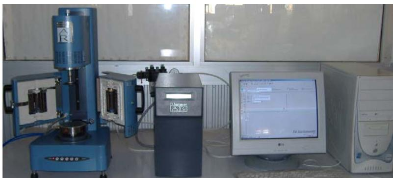
**Figure I.1 :** Image du Rhéomètre AR 2000.
