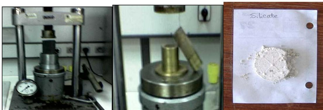
**Figure V.2 :** Figure du montage et de la procédure de préparation des pastilles pour les essais de filtration.
