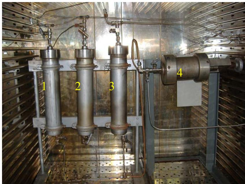
**Figure V.3 :** cellule Hassler pour essais de déplacement (montage de déplacement)
