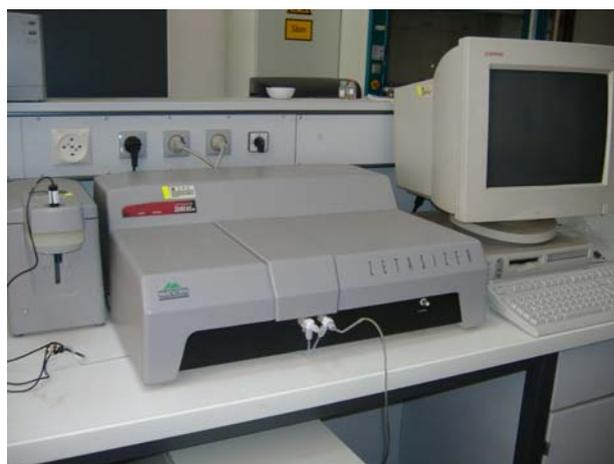
**Figure V.9 :** Zétamètre du type Zétasizer de Malvern.
