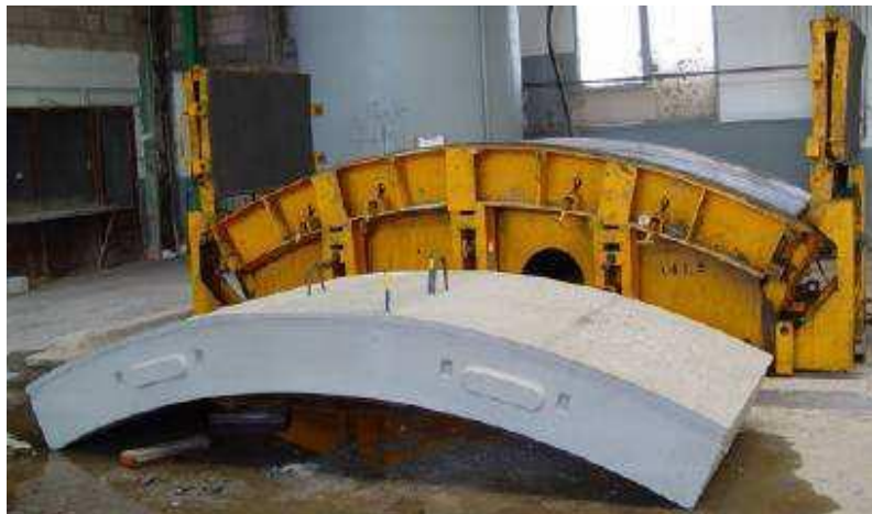
Figure 56 Un voussoir à base de BAP fibré [85]
