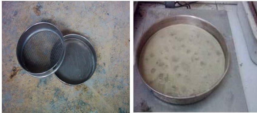
Figure 29: Tamis de 5mm + fond - Mesure de la laitance.
