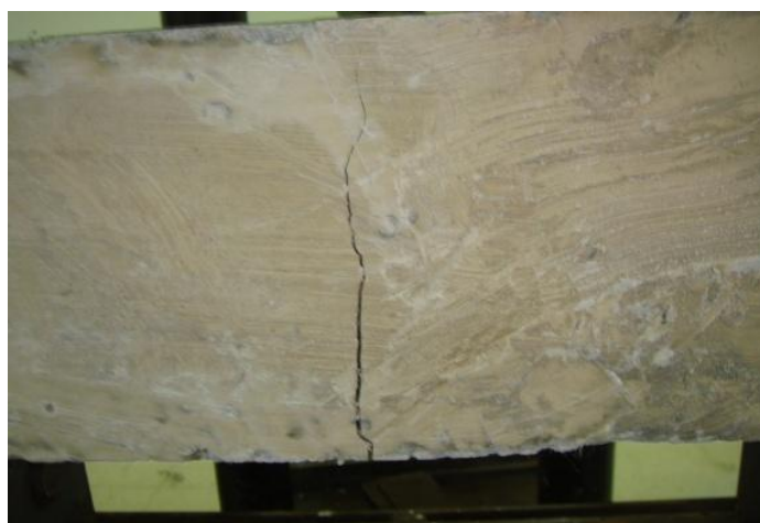
Figure 72 : Eprouvette après fissuration par flexion
