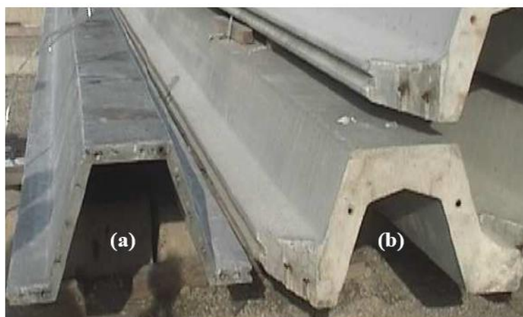
Figure 55 Palplanches précontraintes à base de : mortier autoplaçant fibré (a), béton armé ordinaire (b) [85]
