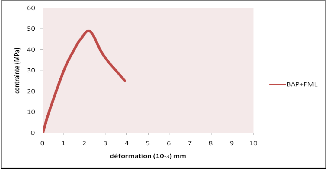
91-2 : Courbe contrainte –déformation pour BAP+FML
