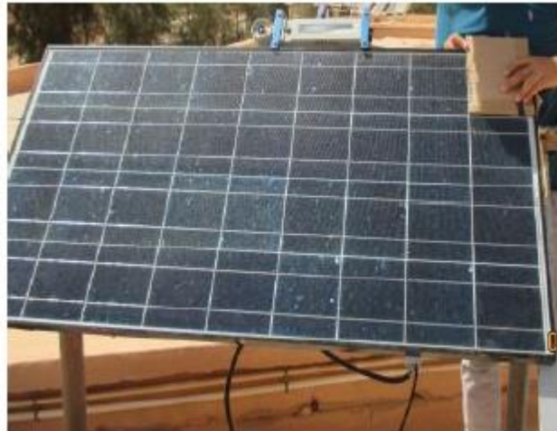
Figure. III. 21 Diode déconnectée + ombrage d'une cellule
