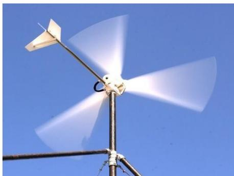
Fig.II.11 Petite éolienne à courant continu [37]
