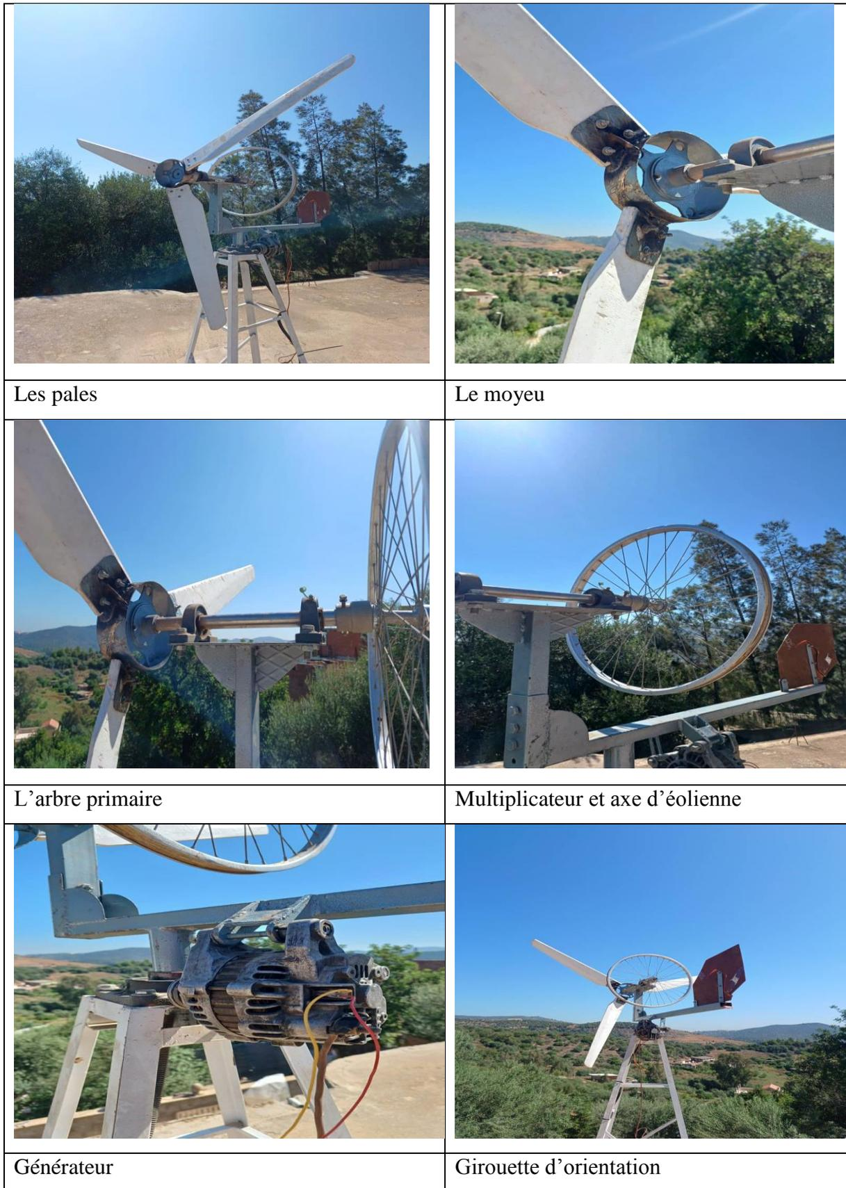
Fig.III.10. Réalisation d'éolienne
