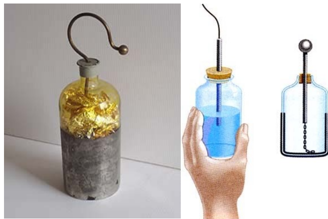
Figure I.1 : Photo (a) et schéma (b) d'une bouteille de Leyde.
