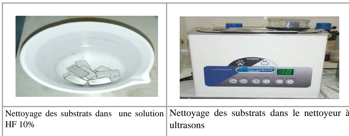
Figure IV.6 : Nettoyage des substrats (acier inoxydable 304)
