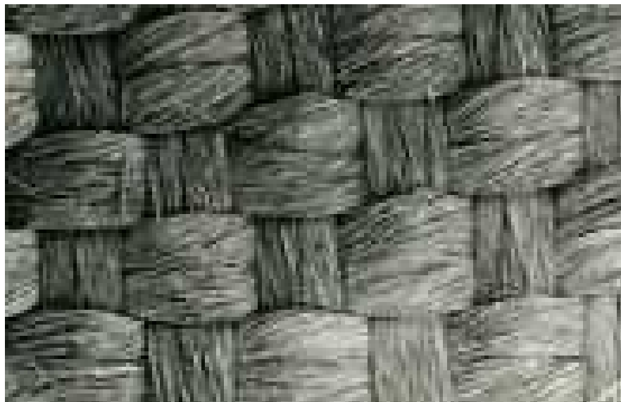
Figure I. 4. Structure microscopique d'une électrode en tissu activé
