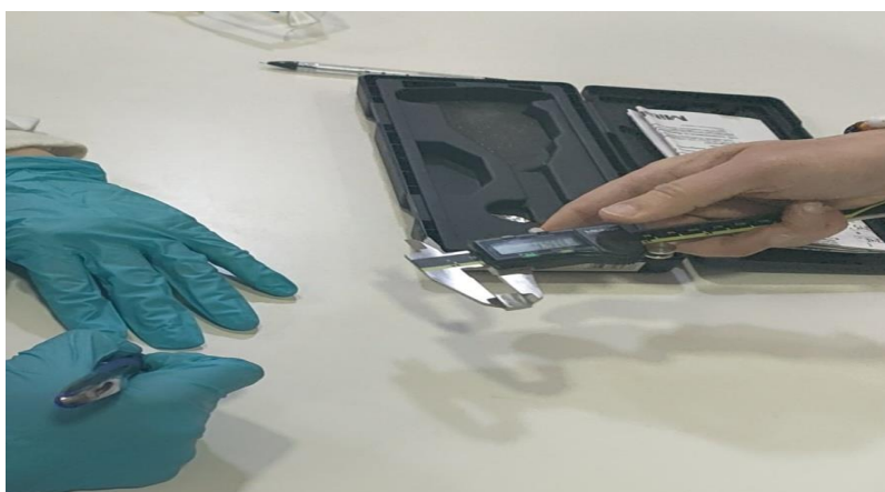
Figure 19: Mesure les dimensions avec pied à coulisse.
